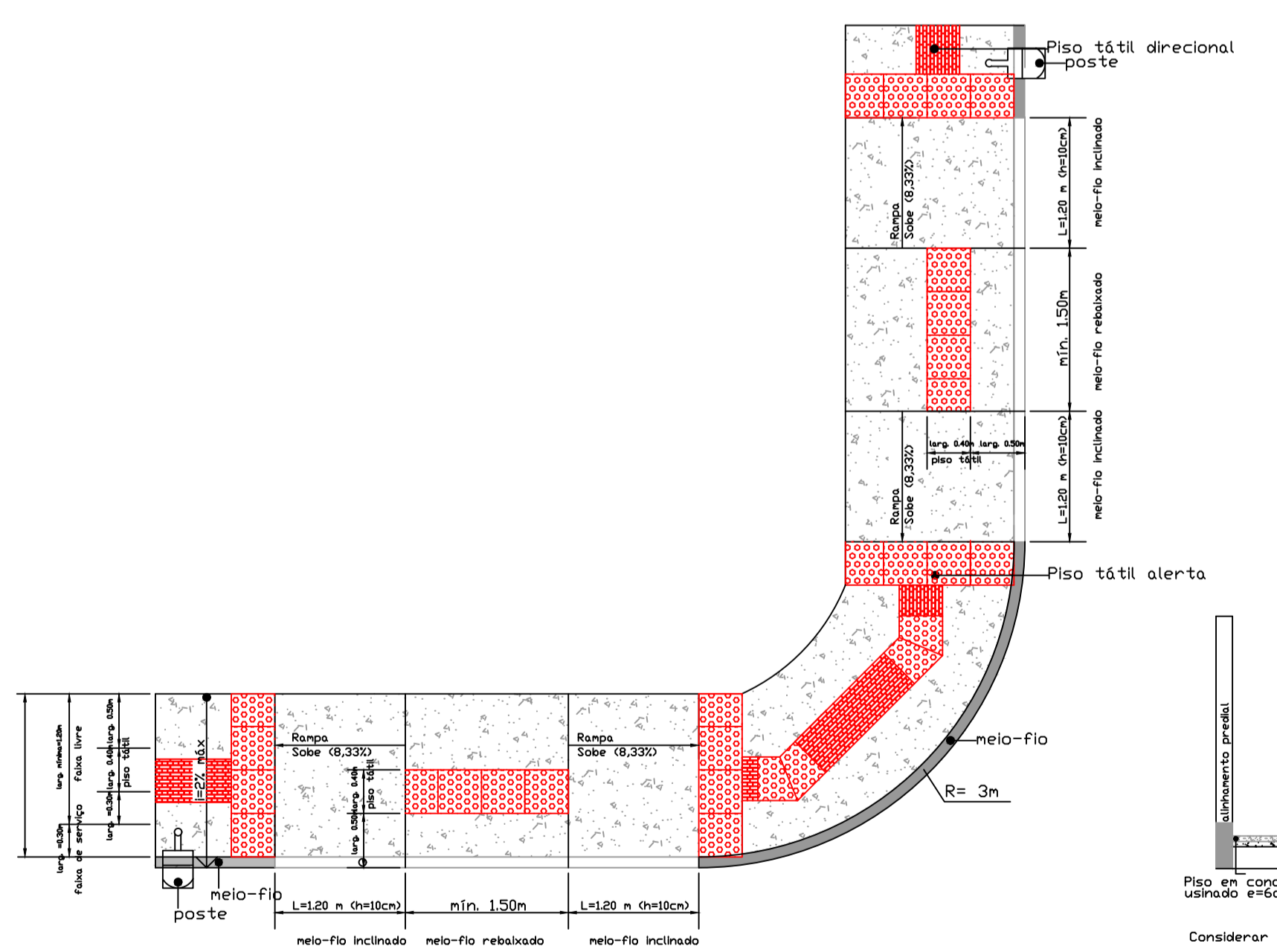
REBAIXO PARA TRAVESSIA DE PEDESTRES
