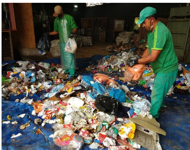
Figura 9 - Rompimentos dos sacos.
